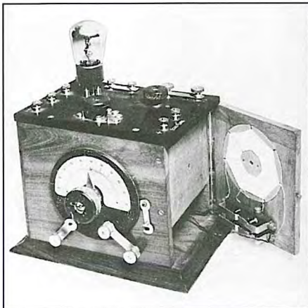
Radioempfänger mit Elektronenröhre. Gebaut um 1930.
