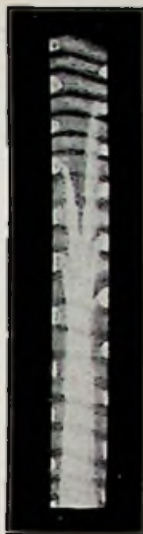
12. Funkenbild nach Feddersen nach Teilentladungen innerhalb eines Funkens
