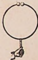
15. Hertzscher Sender und Empfänger
