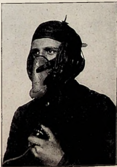
213. Flugzeug-Beobachter mit Ausrüstung für drahtlose Telephonie Telephon und Mikrophon sind schallsicher abgedichtet Der Druckknopf dient zum Umschalten von Sprechen auf Hören
