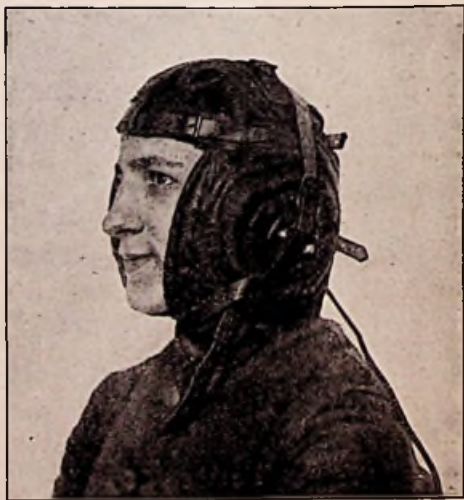
200. Fliegerhaube mit eingebautem Empfangstelephon
