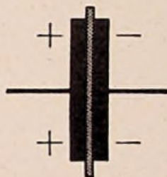
24. Plattenkondensator mit Glas als Dielektrikum
