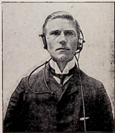
45. Telegraphist mit Empfangsgerät Am linken Ohr des Telegraphisten ein Dosen- hörer; das rechte Ohr ist durch eine Stoff- platte, die am Ende des federnden Kopfbügels befestigt ist, gegen Fremdgeräusch geschützt
