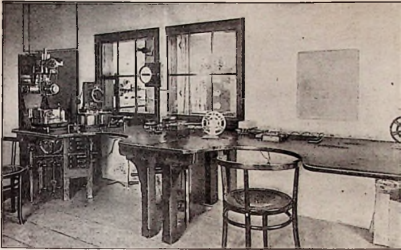
139. Empfangseinrichtung von Nauen im Jahre 1909 Links ein Verstärker, wie er vor Einführung der Hochvakuumröhren verwendet wurde
