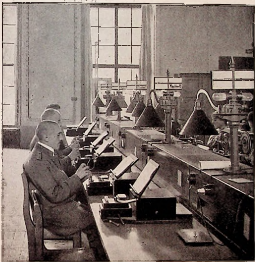
113. Stanzapparat für Wheatstone-Lochstreifen
