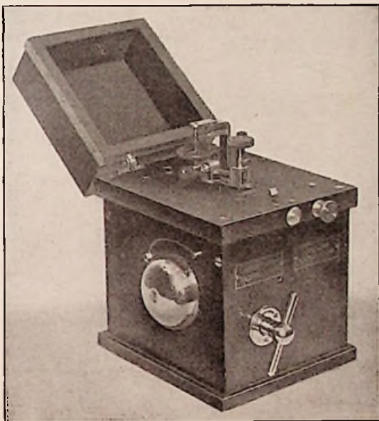
99. Der Schleifer Vorn Griff zum Aufziehen des Uhrwerks. Die Glocke an der linken Seitenwand ertönt kurz vor Ablauf des Uhrwerks
